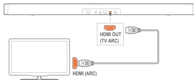
1. Подключите звуковую панель к телевизору при помощи HDMI-кабеля в комплекте.
