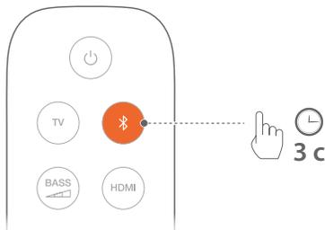
1. В режиме Bluetooth как источника сигнала нажмите и удерживайте **G** на звуковой панели или **Bluetooth** на пульте дистанционного управления, пока не отобразится «**BT PAIRING**».
